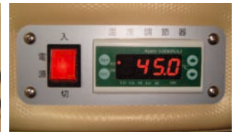
枕元のデジタル温度調節器
